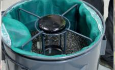
Filtro PPL 300/100 micron para una filtración superior de las virutas más finas
