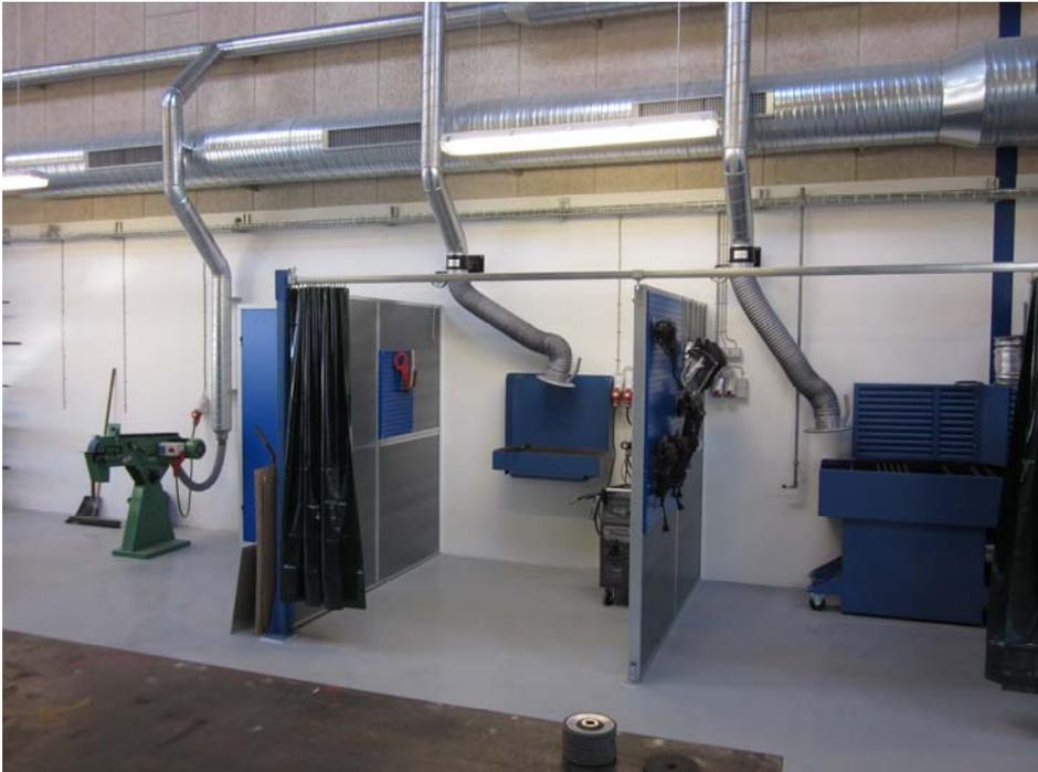
Brazo telescópico de 1-2 metros, diametro 160 mm, con campana metálica de 300 mm rejilla de protección, válvula reguladora de caudal, con salida hacia el conducto para arriba.
